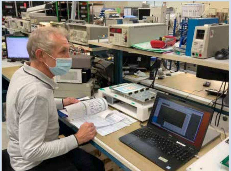
0,2 T. Le *crosstalk* entre voies a été mesuré inférieur à 3% dans tous les cas de figure. *In fine* 64 cartes FEC équiperont les nouvelles TPC pour un total de 36864 voies de mesure. Les 20 cartes supplémentaires serviront de réserve pour la maintenance ainsi que pour équiper les différents bancs de test de la collaboration.
