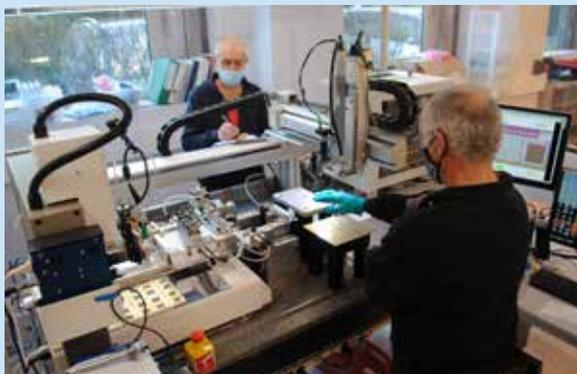
Ensemble du système d'assemblage des plans de détecteur CALICE en cours d'opération. La partie collage et la partie positionnement sont visibles sur la photographie ainsi que la carte électronique COB (Chip on Board) en bas à gauche.
