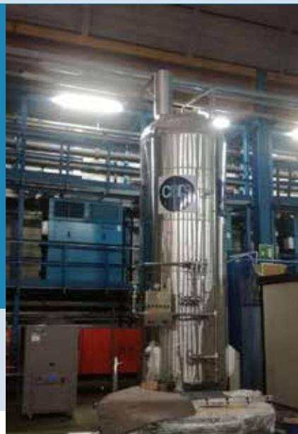
Le système de stockage xénon ReStoX2 dans les sous-sols du LNGS.
