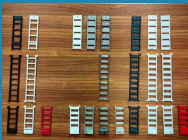
Études et essais de différents matériaux pour les unités supports (SU) : fibre de carbone T300 usiné, ABS (Acrylonitrile Butadiène Styrene) imprimé 3D, Accura® 25 imprimé 3D, PEEK (Polyether Ether Ketone) imprimé 3D ou usiné. Ce dernier (PEEK usiné) est le matériau cible retenu à ce jour (fin 2021).
