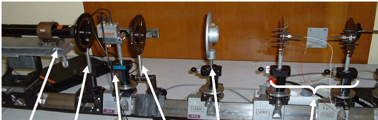
Laser polariseur Pockels analyseur lentille fibres optiques
