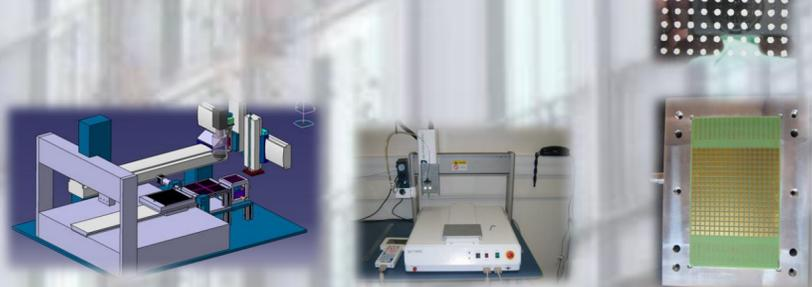
Afin de maximiser les performances du calorimètre, le service a conçu et réalisé des modules de détecteurs en silicium. La minimisation de la quantité de matière, l'emploi de matériaux composites et la précision de positionnement ont été des contraintes permanentes. Les concepts ont été testés en grandeur réelle, notamment pour la précision de positionnement et la maîtrise des dépôts de colle, grâce au développement d'outillages spécifiques.
