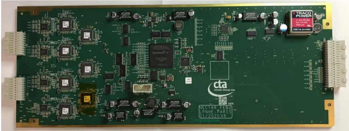
Carte Front-End Board conçue au LPNHE pour l'acquisition, le traitement et le déclenchement du signal Cherenkov pour NectarCAM. Crédit LPNHE/J.-L. Meunier.
