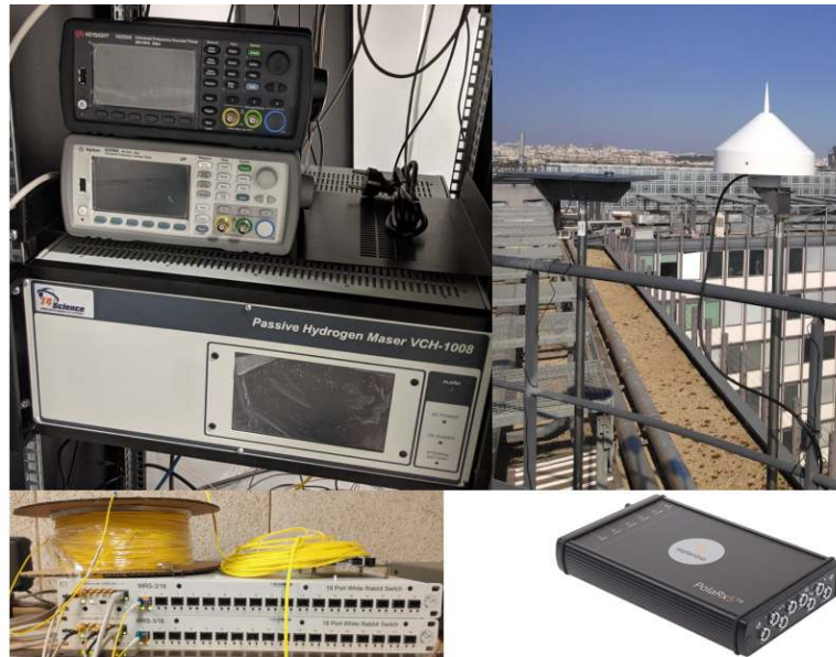
Les différents instruments pour la génération d'horloge qui font partie du « timing lab » du LPNHE. Crédit Vincent Voisin.
