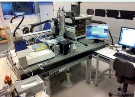
Robot de positionnement et de collage de capteurs silicium sur des cartes électroniques.
