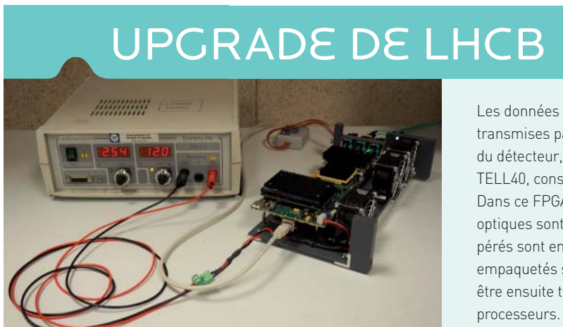
Le système MiniDAQ (design CPPM), intégrant une carte TELL40 au format AMC et une carte mère hébergeant un processeur embarqué de contrôle et monitoring, est utilisé pour évaluer les différentes options de firmware de l'électronique back-end du détecteur SciFi.
