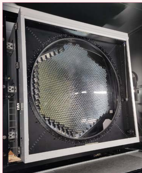
Photo 1 : Caméra NectarCAM en phase de tests en chambre noire au CEA/Irfu.
