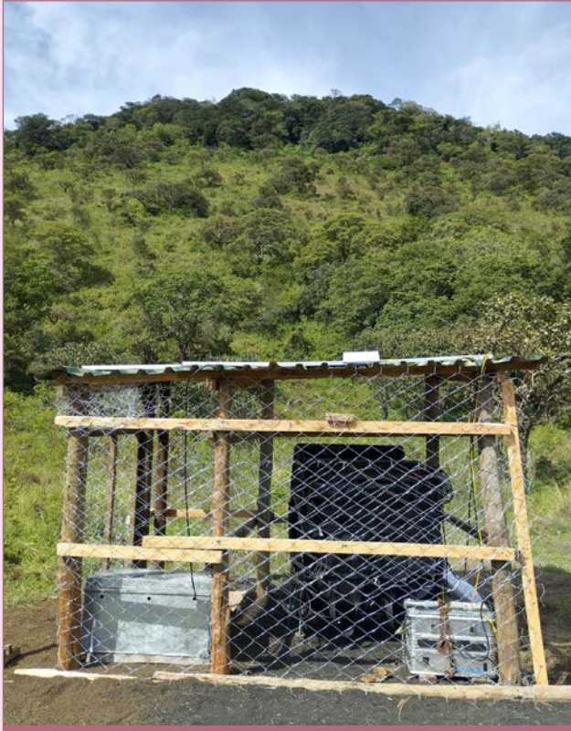
Un détecteur de muons installé dans la chaîne des Chyulu au Kenya. Le détecteur pointe sur une colline de la chaîne afin d'observer les variations saisonnières de son contenu en eau.
