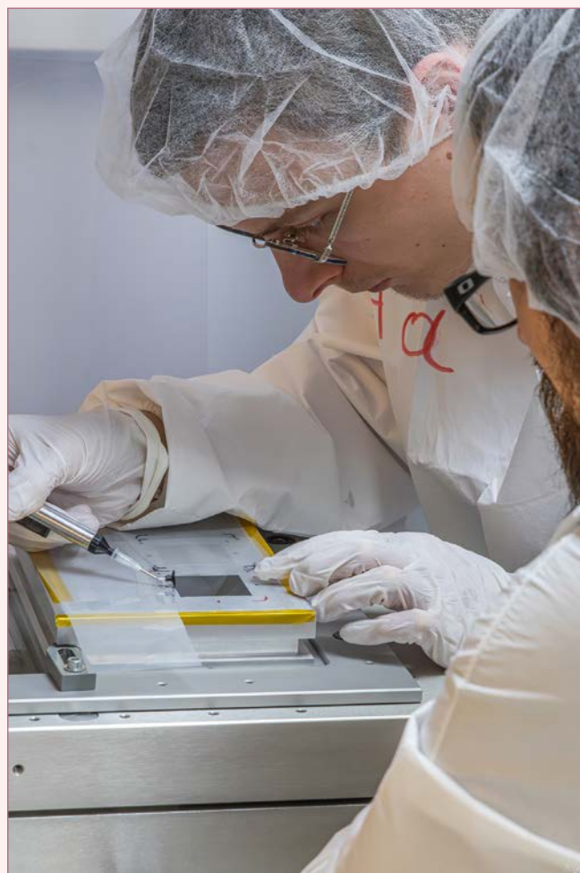
Préparation d'un module nu pour une caractérisation sur la machine de métrologie.
