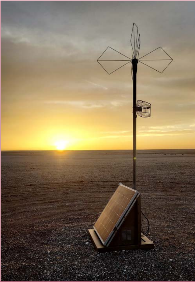
Photo 1 : Une unité de détection sur le site de l'expérience GRANDProto300.
