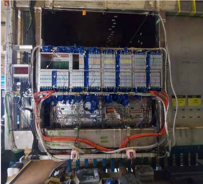
Nouveaux détecteurs (HA-TPC et SuperFGD) installés dans l'aimant du ND280. Octobre 2023.
