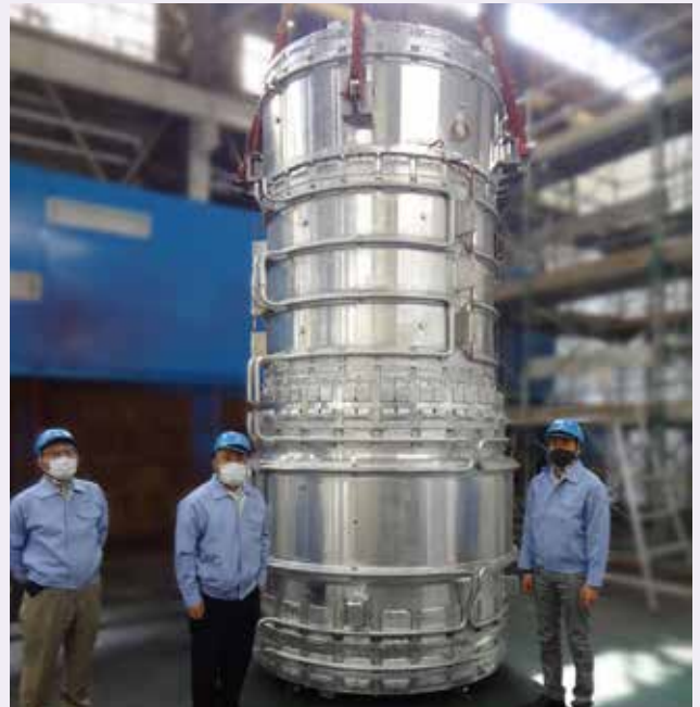
Bobines supraconductrices de gros calibre entourent la cible de production de pions pour la capture de ceux-ci avec un grand angle solide. Le faisceau de muons est produit à partir de désintégrations de pions dans un champ magnétique puissant généré par des bobines solénoïde supraconductrices. Le champ magnétique est conçu pour avoir un pic de 5 T au niveau de la cible.
