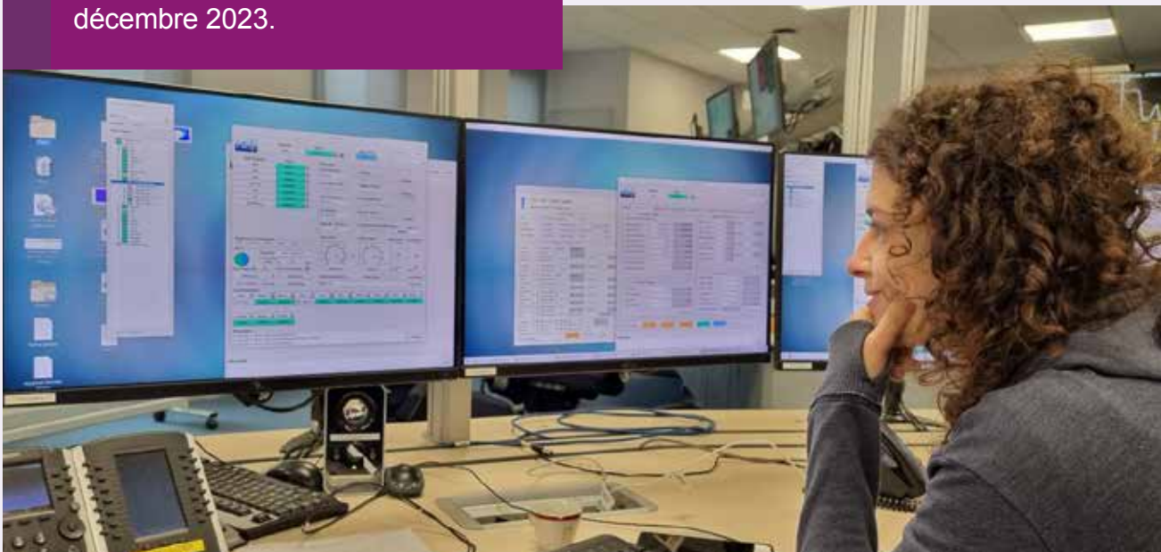
Une post-doctorante du groupe dans la salle de contrôle de LHCb, pendant la première prise de données à 20 MHz avec le système Allen. Les voyants verts sur l'écran confirment que tous les sous-systèmes de LHCb sont fonctionnels et indiquent la bonne condition de la prise de données.
