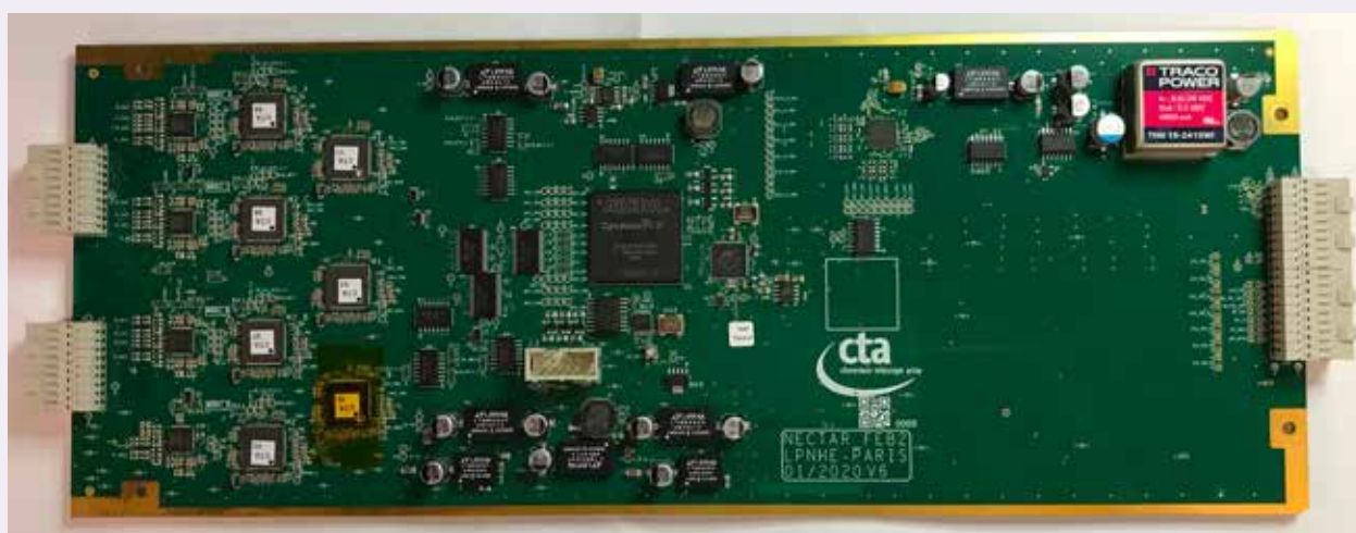
Carte Front End Board (FEB) version 6 développée au LPNHE, équipant la caméra NectarCAM.
