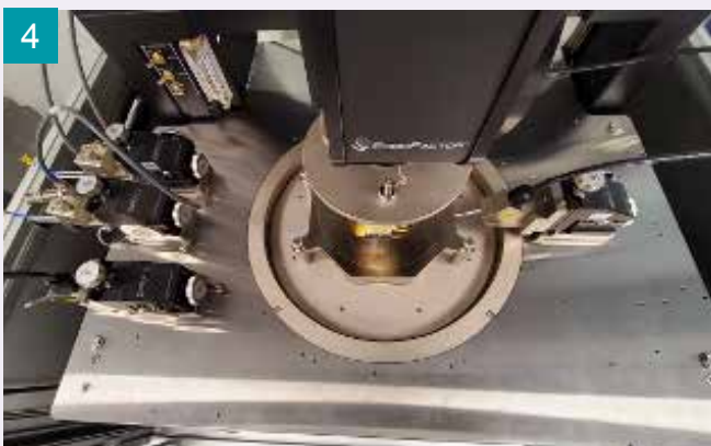
Nouvelle machine de test sous pointes d'ATLAS au LPNHE. La machine est conçue pour effectuer des mesures même à des températures de -55 °C à +200 °C sans effets de condensation, et s'adapte particulièrement aux conditions nécessaires pour les mesures sur les capteurs irradiés.
