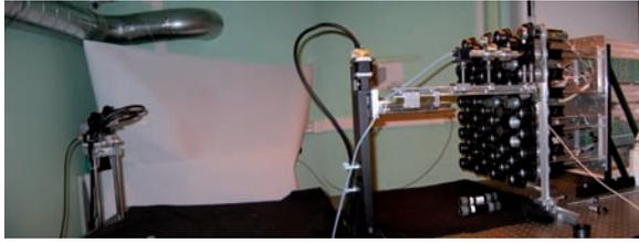
Fig. 6 : banc de test – contrôle automatisé des performances des PM de la caméra HESS II.
