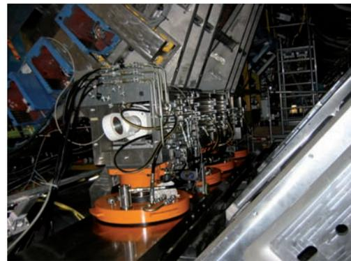
Fig. 1 : ATLAS – calorimètre ENDCAP équipé d'air-pads.
