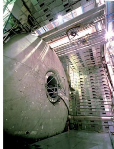
Figure 1 : le cryostat central du calorimètre de DØ avec le solénoïde et les chambres à muons.
