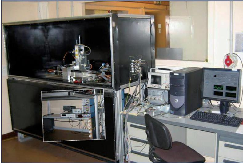
Figure 5 : banc de test de prototype des détecteurs et électronique de lecture associée.
