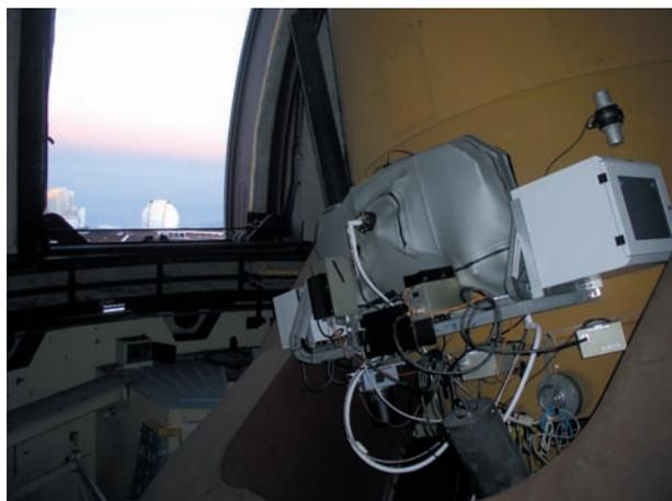
Figure 3 : le spectrographe intégral de champ SNIFS (Supernova Integral Field Spectrograph) sur le télescope de Mauna Kea à Hawaïi.
