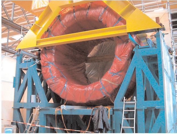
Figure 2: vue d'un demi baril du calorimètre, posé sur le bâti d'insertion.
